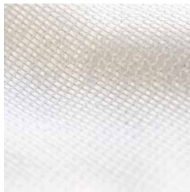
Detail van een laag van het snijbeschermingsmateriaal: de afzonderlijke vezels zijn met elkaar vervlochten in de lengte- en dwarsrichting.
